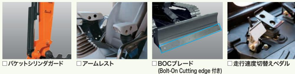
□ バケットシリンダガード □ アームレスト □ BOCブレード (Bolt-On Cutting edge 付き) □ 走行速度切替えペダル
