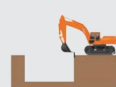
トンボに刃先を合わせて基準点を設定します。
