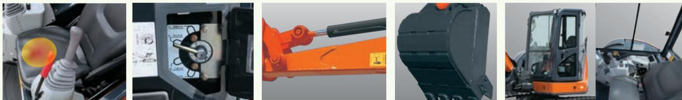
□ シートヒータ (ヒータ内蔵シート) □ セレクタバルブ式マルチレバー (4way) □ 4面補強付きアーム □ 側面、底面補強バケット □ キャブ
