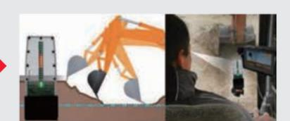
キャビンからバケットの刃先の位置を常時確認しながら掘削作業ができます。LEDディスプレイの表示が緑の場合は、刃先の位置が正しいポジションになります。
