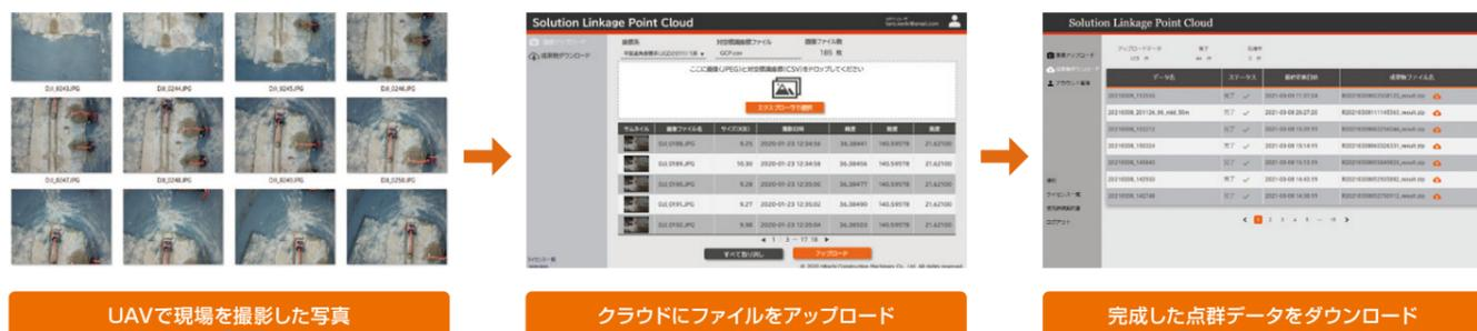
※ 時系列でデータを比較したり、起工測量データと比較する場合は、現場に標定点と検証点を設置してトータルステーションなどで座標計測し、クラウドでの点群生成の際に入力が必要です。専用の標定点マーカースでない場合は、別途写真1枚ごとに座標指定してください。
